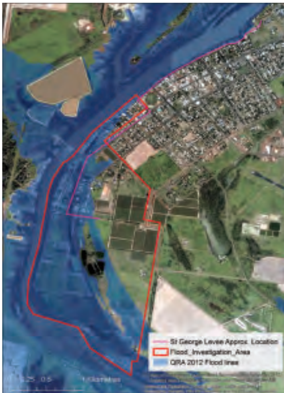
図2 バロン川のセント・ジョージ付近の位置関係と2012年の洪水浸水域。青いエリアが浸水域、ピンク色の線が堤防のおおよその位置を示す。
