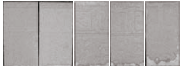
写真5 凍害劣化程度と評価値
