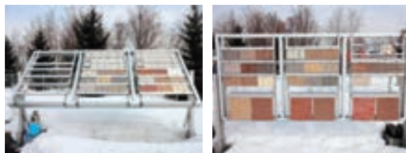
写真1 直接暴露試験の例（北総研）
