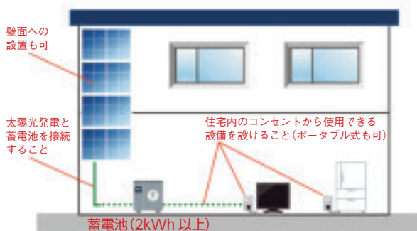
図2 太陽光発電と蓄電池の設置要件のイメージ
