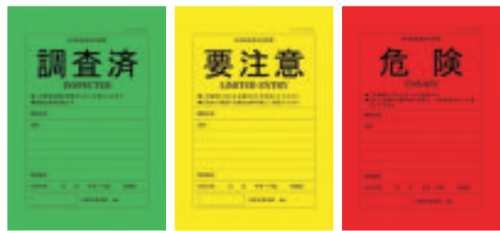
判定済みの建物に掲示されるステッカー
