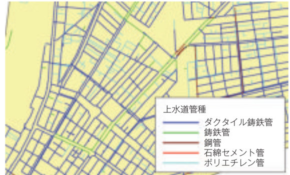
図5 上下水道管路データの構築例
