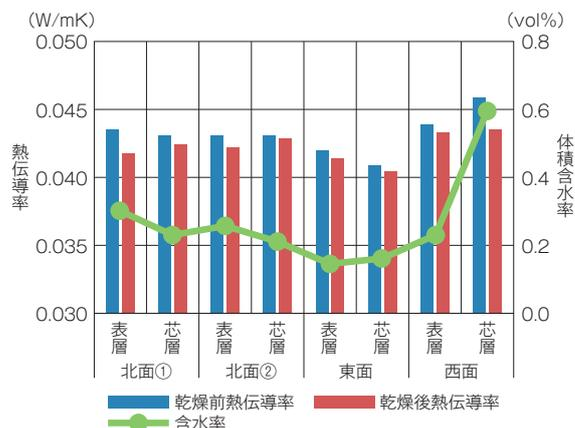
図1 32年が経過した外断熱パネル断熱材の乾燥前後の熱伝導率と体積含水率<sup>2)</sup>
