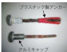
写真5 主アンカーの概要
