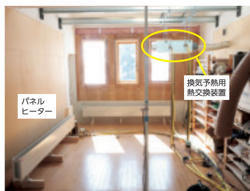
写真3 模擬装置を導入した実験棟内部
