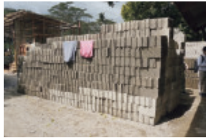
写真2 家内工業的に製造される CHB、骨材は粒度1mm に満たない火山灰、割合は目分量、天日干し（写真提供：米澤稔氏）
