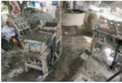
写真2 家内工業的に製造される CHB、骨材は粒度1mm に満たない火山灰、割合は目分量、天日干し（写真提供：米澤稔氏）
