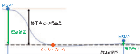
図2 標高補正のイメージ (断面)
