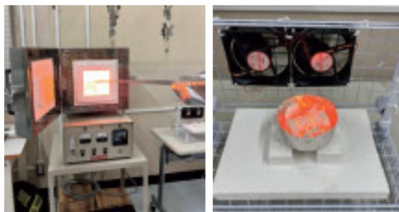
図1 C<sub>3</sub>S製造 (左: 1300°Cで炉から取り出し、右: 急冷中のC<sub>3</sub>S)
