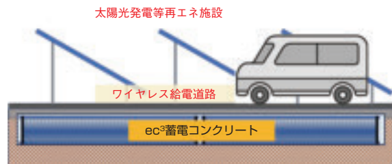
図11 ec³蓄電コンクリートを利用する給電道路
