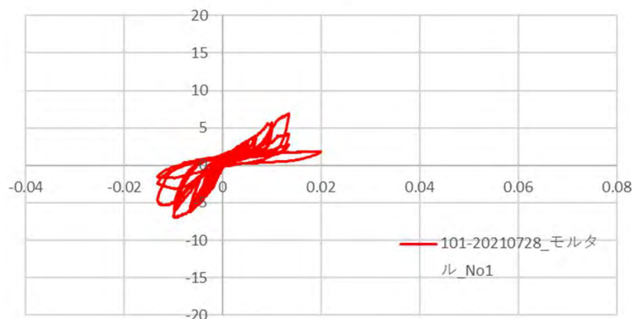
既存モルタル木摺り壁の補強効果の試験結果
