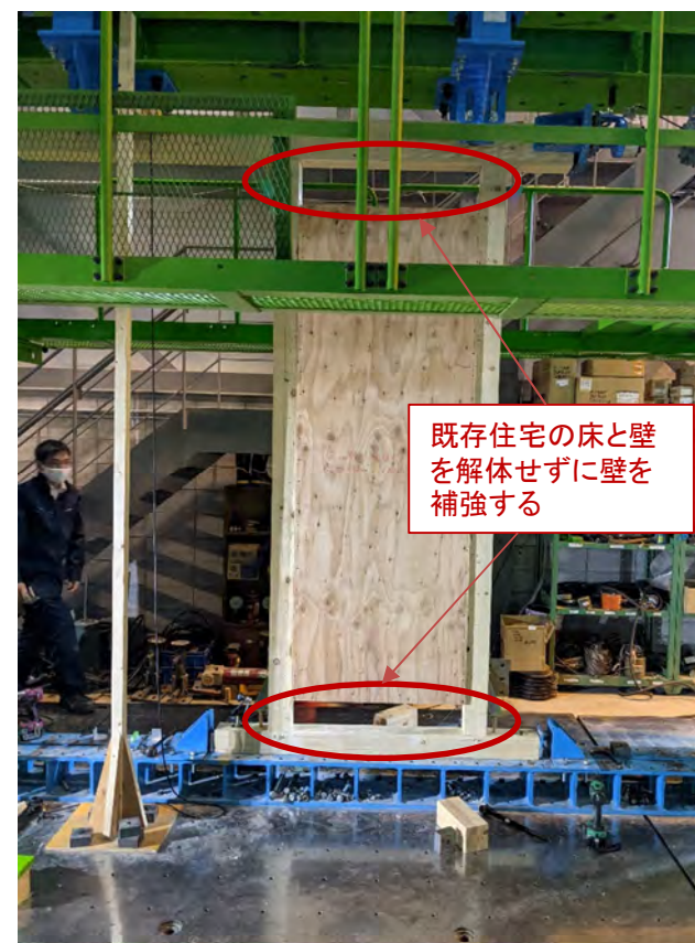
合板耐力壁の加力状況 (上下空き 準耐力壁仕様)
