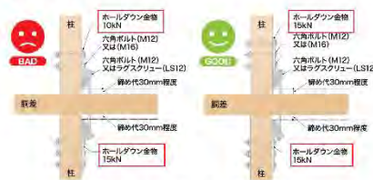
図 4-10 ホールダウン金物選定の考え方
