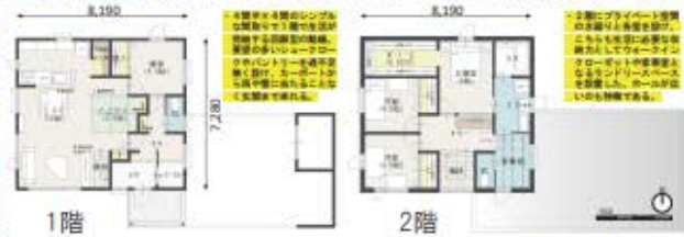
■各層平面図（地域連携の大型パネル工法で、シンプルながら断熱性によってパネル化を実現したプラン）
