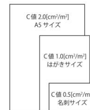
住宅の隙間量のイメージ (40 坪程度の住宅の場合)
