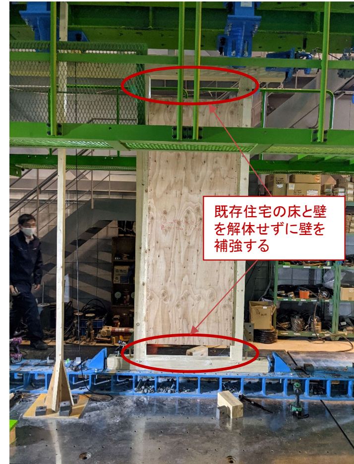
合板耐力壁の加力状況 (上下空き 準耐力壁仕様)
